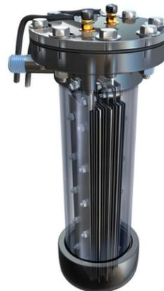
El HYPOGEN de ChlorKing® utiliza tecnología de flujo único para producir HOCl, a diferencia de la mayoría de los generadores de HOCl disponibles en el mercado. Otros sistemas de agua electrolizada utilizan una membrana que separa el cátodo del ánodo, produciendo anolito (HOCl) y catolito (hidróxido de sodio), lo cual es muy poco confiable y requiere un mantenimiento frecuente, además de que requiere que el hidróxido de sodio se desperdicie, ya que es un subproducto de la producción de HOCl.
